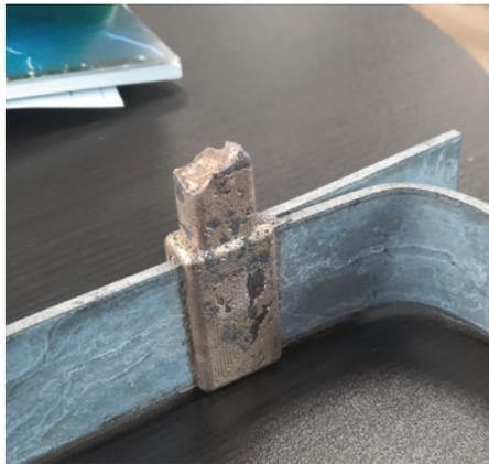
Прочный сварной шов с незначительными поверхностными дефектами.
