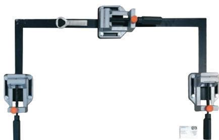
Струбцина предназначена для фиксации стержней заземления и/или свариваемых проводников (провод, полоса) с целью снятия дополнительной механической нагрузки на форму при проведение сварных работ. Использование струбцины значительно продлевает срок службы сварной формы.
