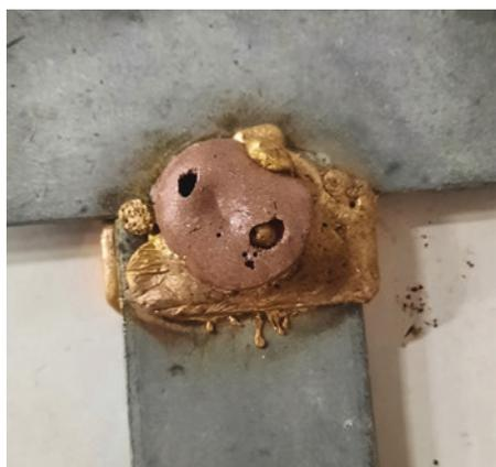
Низкая заливка. В пределах шва виден свариваемый проводник.
