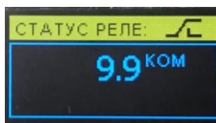
Рисунок 3 – Главный экран в режиме измерения уровня изоляции
